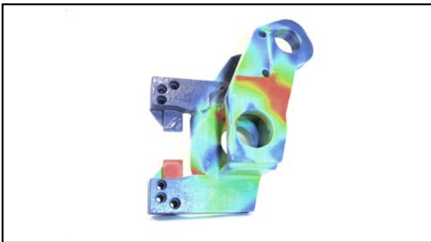
Abb. 7. Modell einer Drahtschere (FEM-Simulation)
