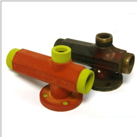
Oben: Das Digital Factory-Team setzte 3D-Scans und 3D-Drucken ein, um beschädigte Artefakte aus dem 19. Jahrhundert im Beamish Museum des County Durham zu ersetzen.
