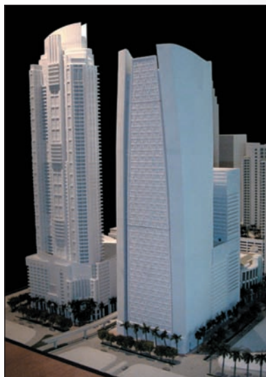
Realization Group 采用 ZPrinter 310 Plus 制作了这款 28 英寸高的迈阿密 “The Met” 建筑物模型，所用时间和成本为传统建筑模型制作方法的四分之一。
