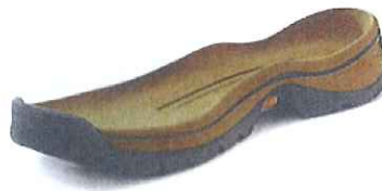
Bei Timberland besteht die Herausforderung darin, eine größere Anzahl an Schuhprototypen herzustellen, um Tragekomfort, Belastbarkeit und Vermarktungspotenzial neuer Designs besser bewerten zu können. Die Lösung ist der Einsatz eines ZCorporation 3D ZPrinter. Bild: Timberland
